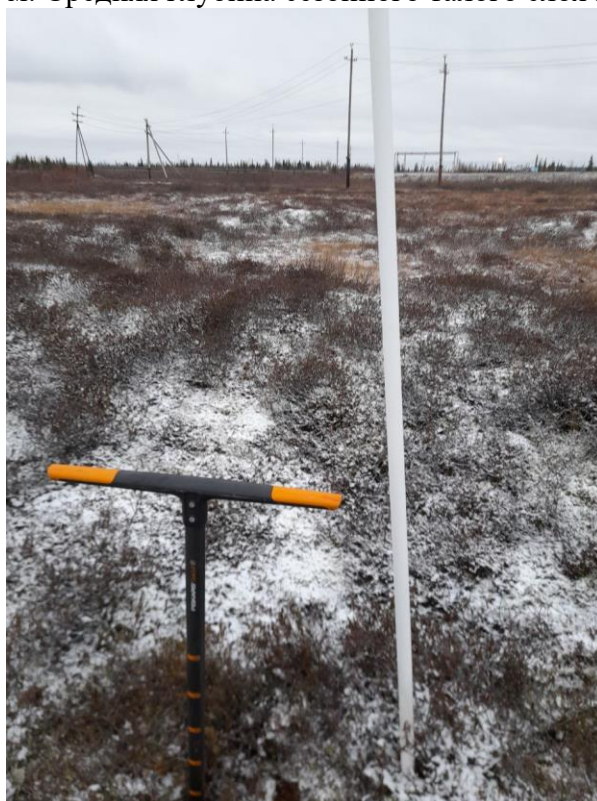
Рис. 1.5. Измерение глубины оттаивания грунта
